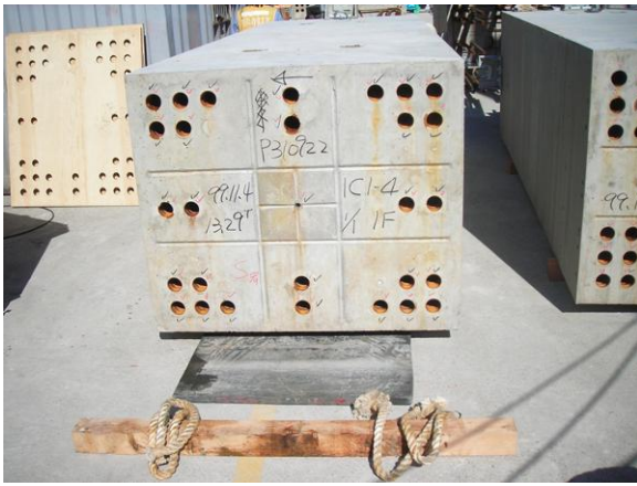
图 17 柱底软性橡胶垫
