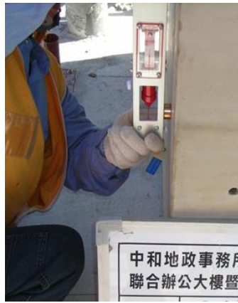
图 21 防风型垂直尺细部
