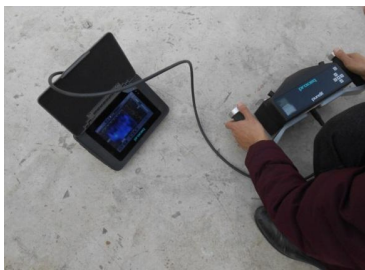
图 C.4(a) 叠合板检测现场
