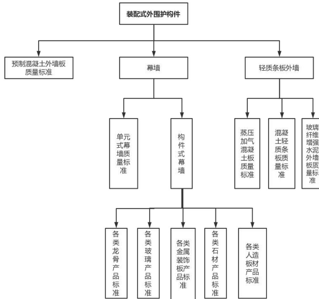
图 4 装配式外围护部品质量标准体系框架
