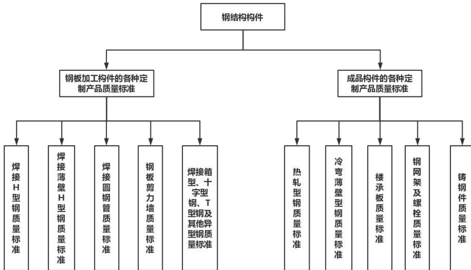
图 3 钢结构构件质量标准体系框架
