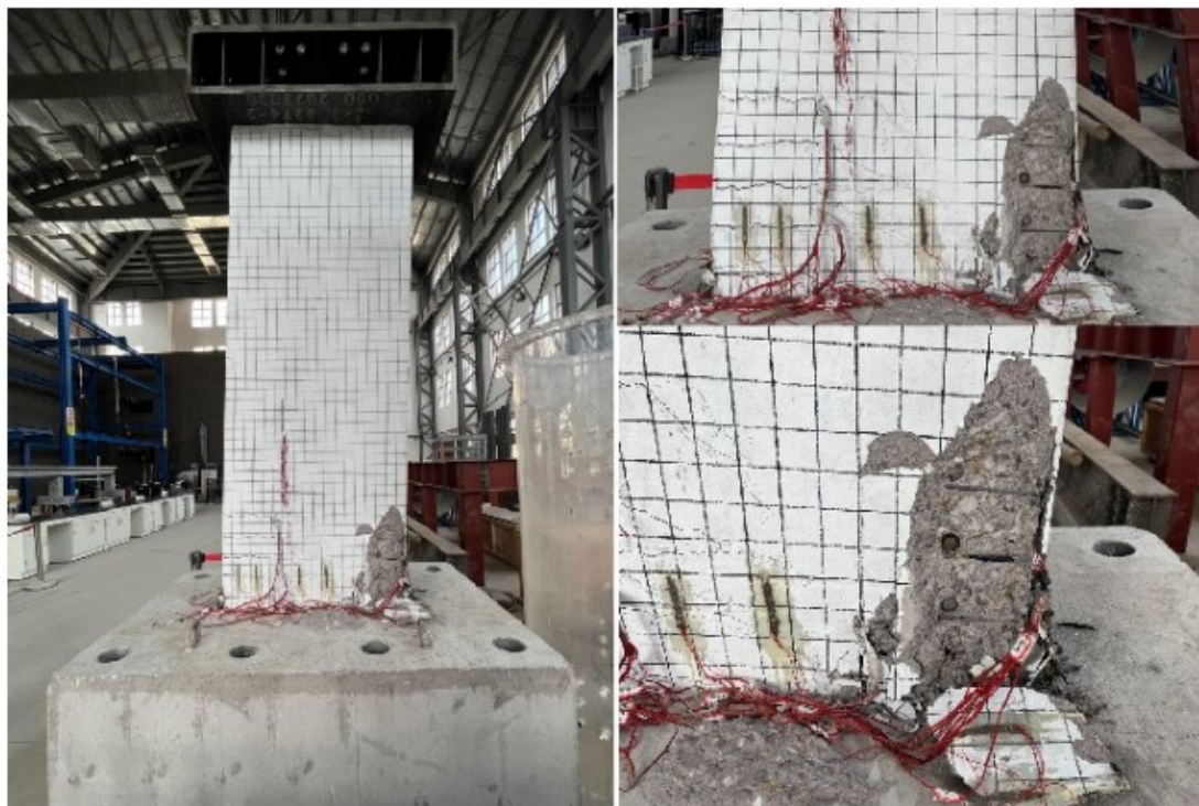
图 4-6 PEC剪力墙的试件破坏照片
